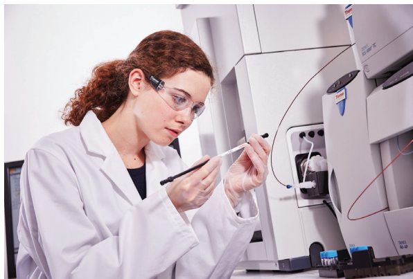
与 Dionex ICS-5000 IC 系统配套的 iCAP RQ ICP-MS
